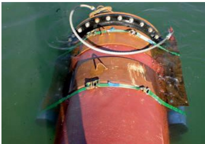
Fig. 5.1 Draghuvud med flytkroppar (PE-rör).
